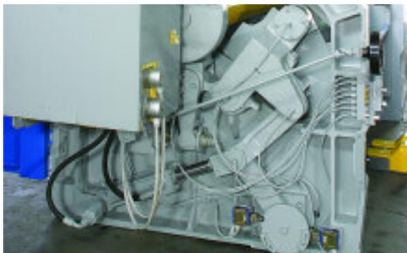
La versione MVN CR, con cilindro pressore cromato lucidato a specchio, è dotata di un sistema di riscaldamento con circolazione forzata di olio diatermico per garantire un rapido raggiungimento della temperatura impostata, il mantenimento di una temperatura costante e la massima sicurezza di utilizzo.
